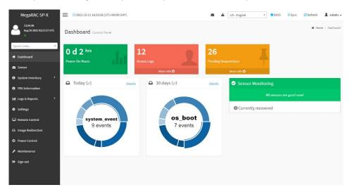
Puede realizarse el control tanto desde equipos Windows como Linux. Además permite toda la gestión completa de KVM sobre LAN, es decir, apagado y encendido de las máquinas, actualización de bios, control de temperatura, revisión preventiva de posibles averías hardware, control remoto del sistema operativo.
